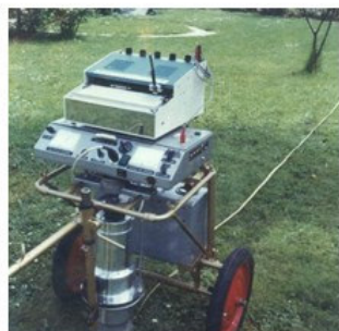
Jacob Stängles Messwagen mit Szintillationszähler und Linienplotter
