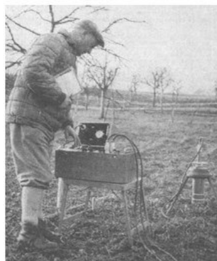
Jacob Stängle bei Messungen mit dem Szintillationszähler
